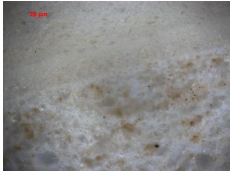
Рисунок 5 – Микроструктура двухслойного тигля вблизи границы раздела слоев плавленного кварца и синтетического оксида кремния,  $\times 250$
