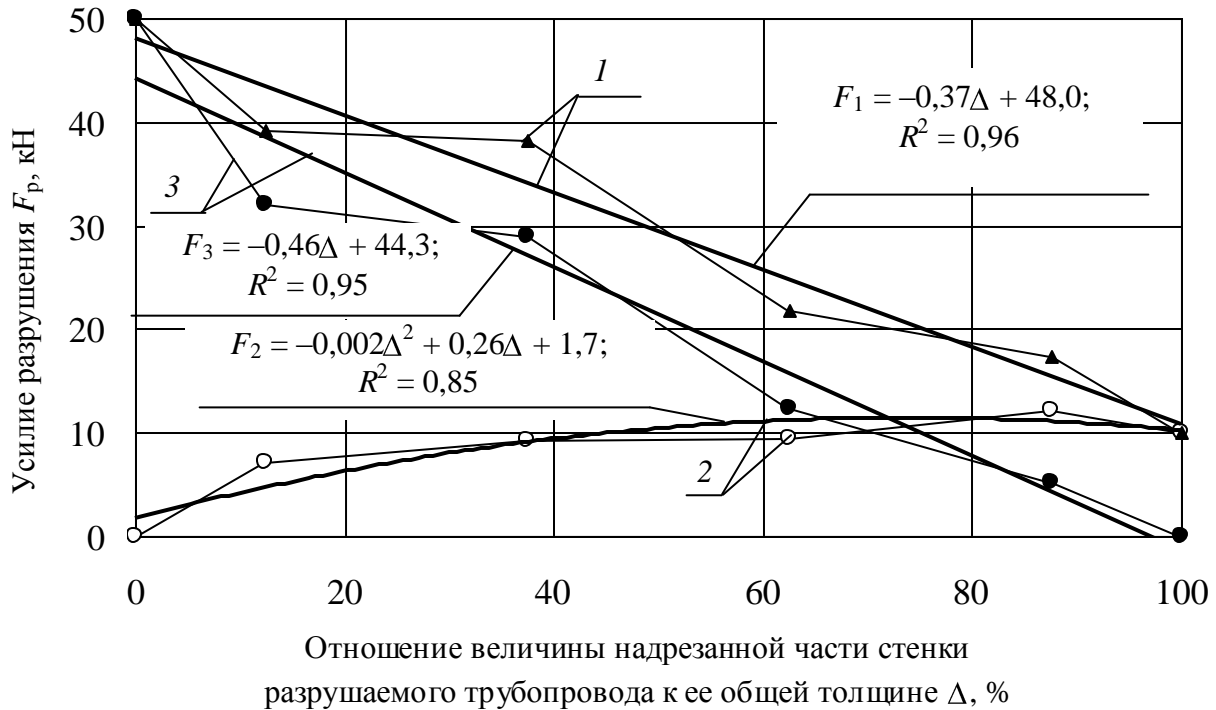
Рис. 3. Результаты исследования различных схем разрушения отработавших трубопроводов: 1, 2, 3 – усилия соответственно суммарные, разрезания и разрыва для стального трубопровода с диаметром d_c = 0,068 м и толщиной стенки \delta_c = 0,004 м
