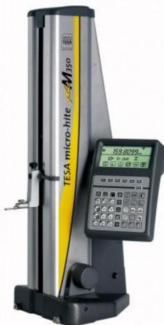
Рисунок 1 - Высотомер TESA MICRO-HITE plus M 350
