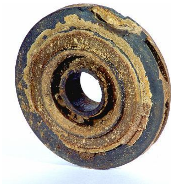
Рис. 1 Многочисленные изъязвления и коррозия, вызванные скоплением солеотложений
