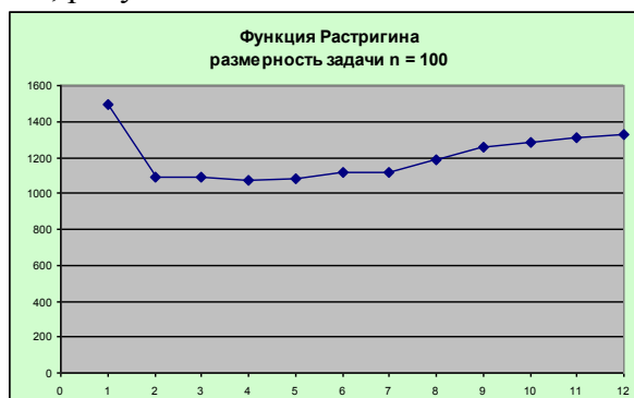
Рисунок 2 –Показатель “среднее значение функции”, полученный алгоритмом PSO, для функции Растригина
