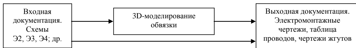
Рис. 1. Основные стадии проектирования кабельно-жгутовой обвязки изделия
