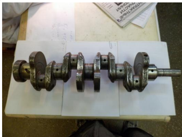
Рис.3 Вал после восстановления.
