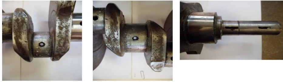
Рис.4 Шейки вала после восстановления и механической обработки.
