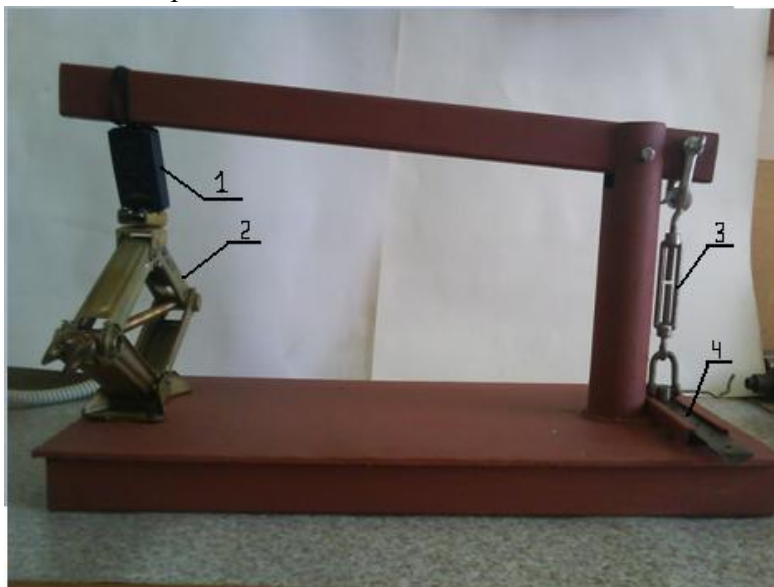
Рисунок 2. Устройство В.Грачева для испытания прочности сцепления.
