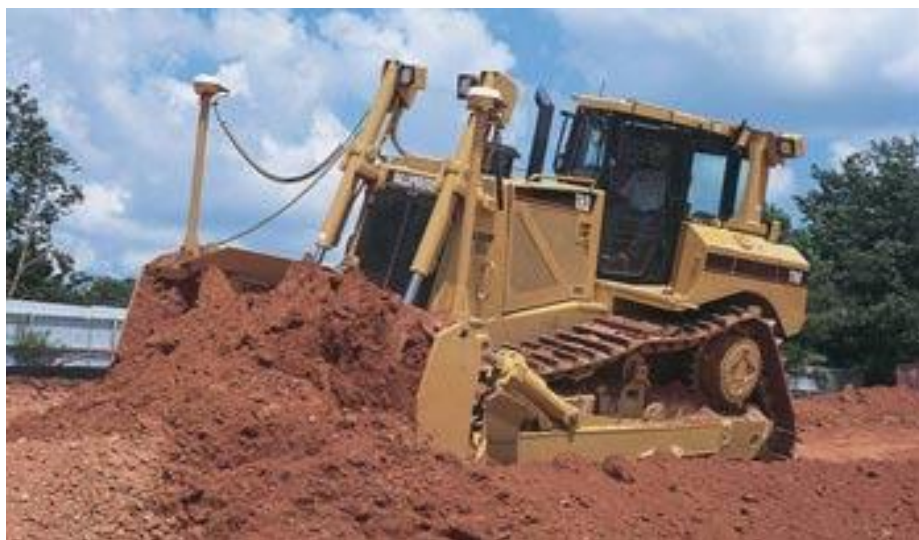
Рисунок – Бульдозер с трехмерной системой нивелирования
