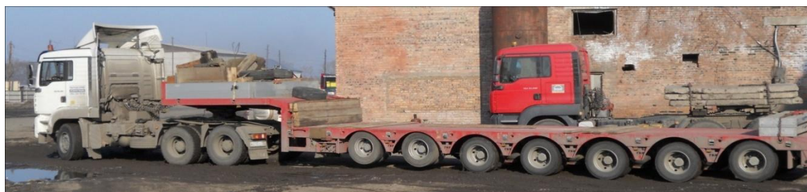
Рис. 5. Полуприцеп грузоподъемностью 90 т фирмы STR.
