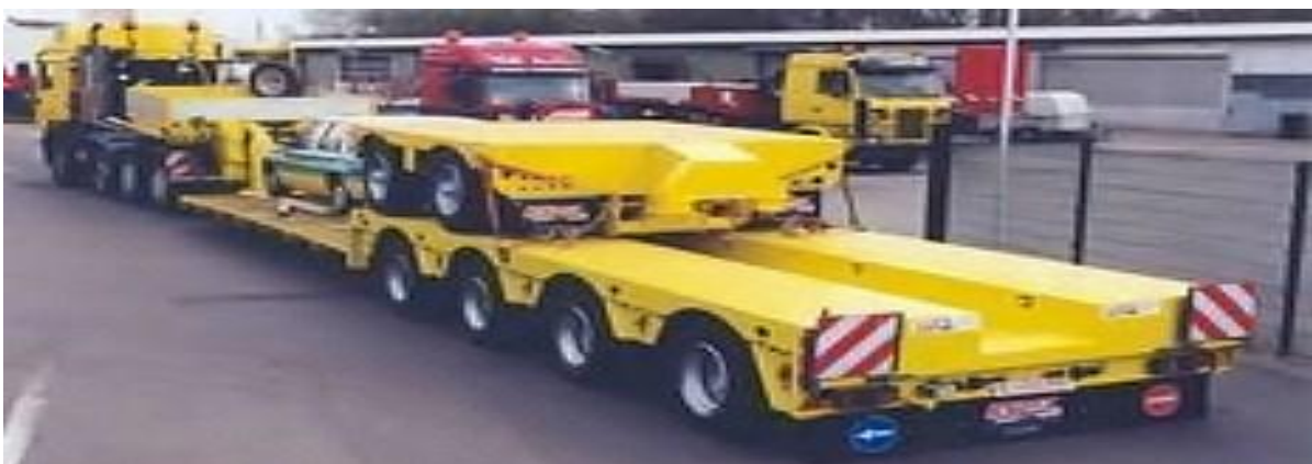
Рис. 3. Строительный трал Nooteboom 40/60 т
