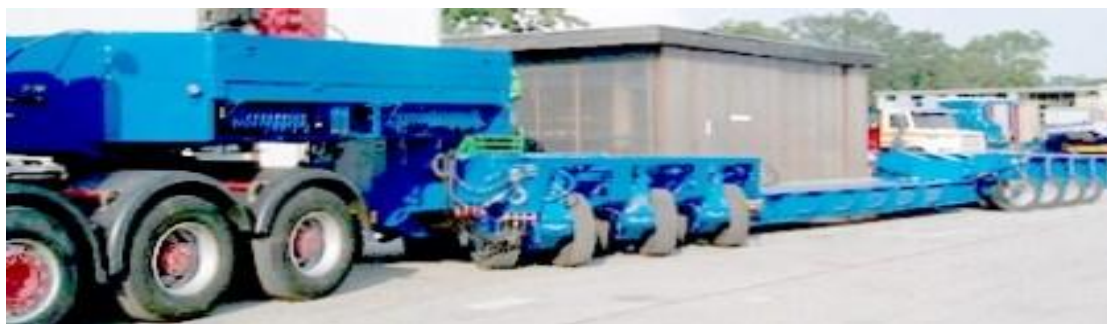
Рис. 4. Модульный трал Goldhofer 160 т
