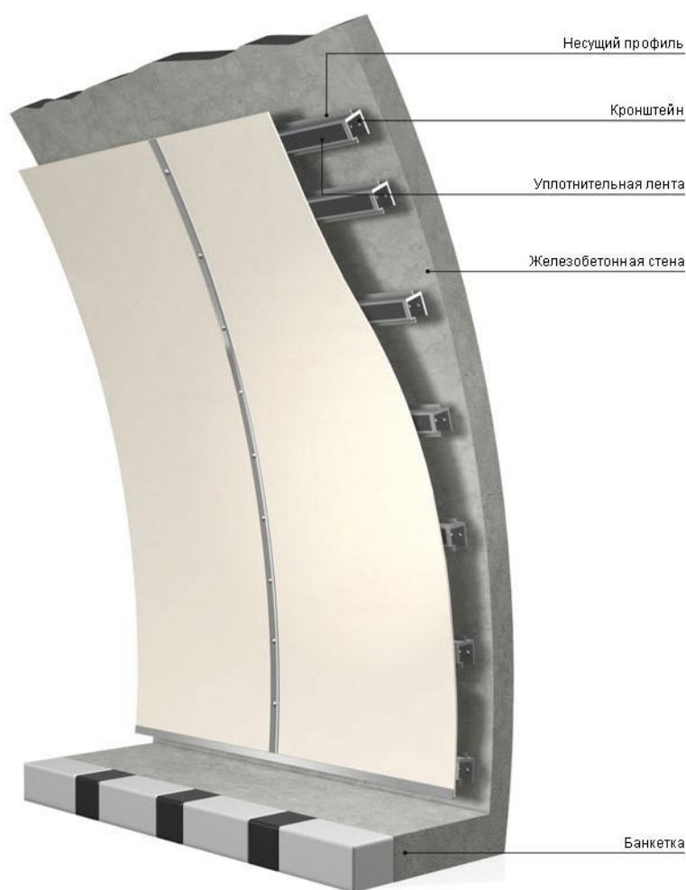
Рисунок 2. Облицовка участка тоннельного способа работ
