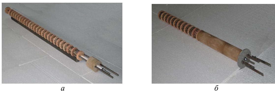
Рис. 2. Трубчатые нагревательные элементы конструкции ООО «НПЦ Магнитной гидродинамики» для внепечных установок: а) для установок фильтрации сплавов PDBF; б) для установок рафинирования сплавов SNIF.
