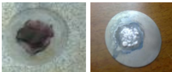
Рис.2. Результаты качественного определения Мо (а) и W (б) в пластинах высокоточных диодов
