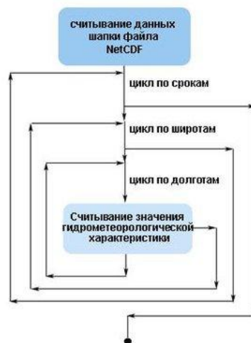
Рисунок 2 - Структурно-логическая схема обработки файла формата NetCSDF (ASCII)
