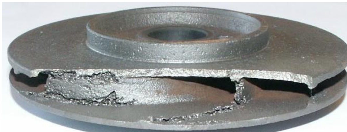
Повреждения, наносимые эффектом кавитации (часть насоса)
