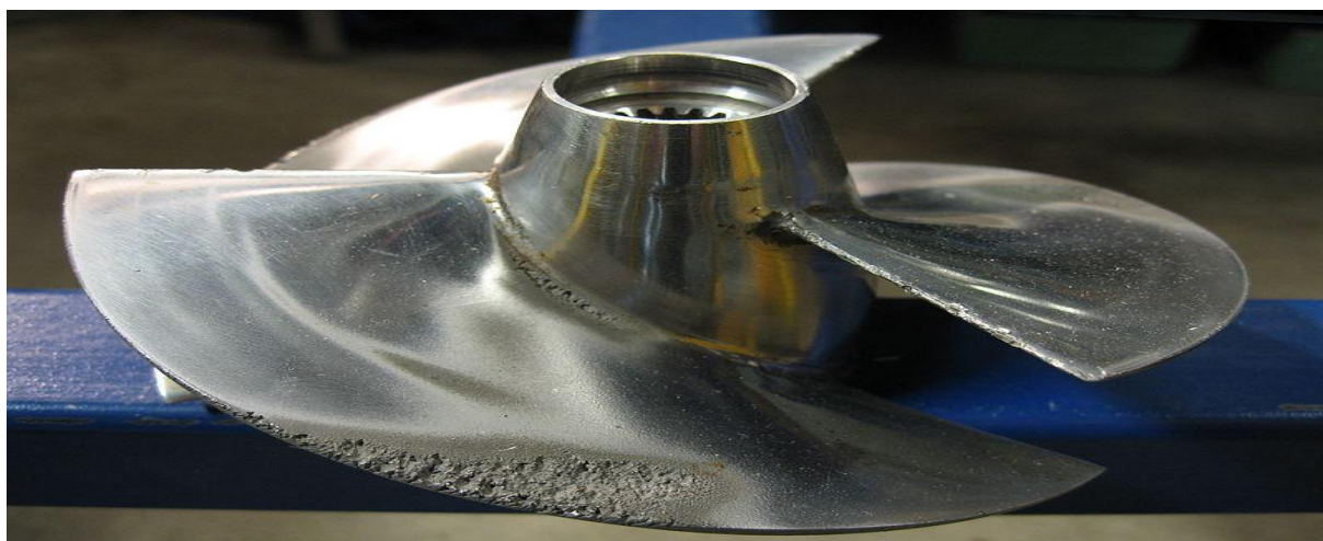
Кавитационные повреждения гребного винта
