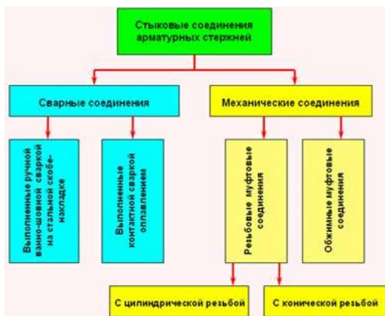
Рис. 1 – Основные способы соединения встык арматурных стержней
