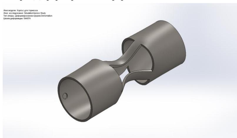
Исходя из результатов статического исследования корпуса для тормозов, можно сделать вывод: при изменении нагрузки, опасная зона может изменять величину области воздействия на участки детали. Таким образом, используя SolidWorks Simulation и пакет COSMOS Works, можно оптимизировать размеры детали на основе выполненных расчетов или изменить материал. Расчет всех компонентов входящих в устройство позволит обеспечить его высокую работоспособность.
