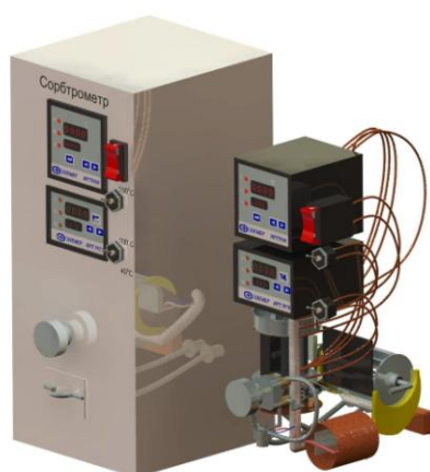
Рисунок 1. Внешний вид автоматизированного устройства для измерения удельной поверхности дисперсных и пористых материалов.
