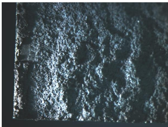
Рисунок 2. - Фотографии излома металлокерамики УМБ – 4с (x 0,65).
