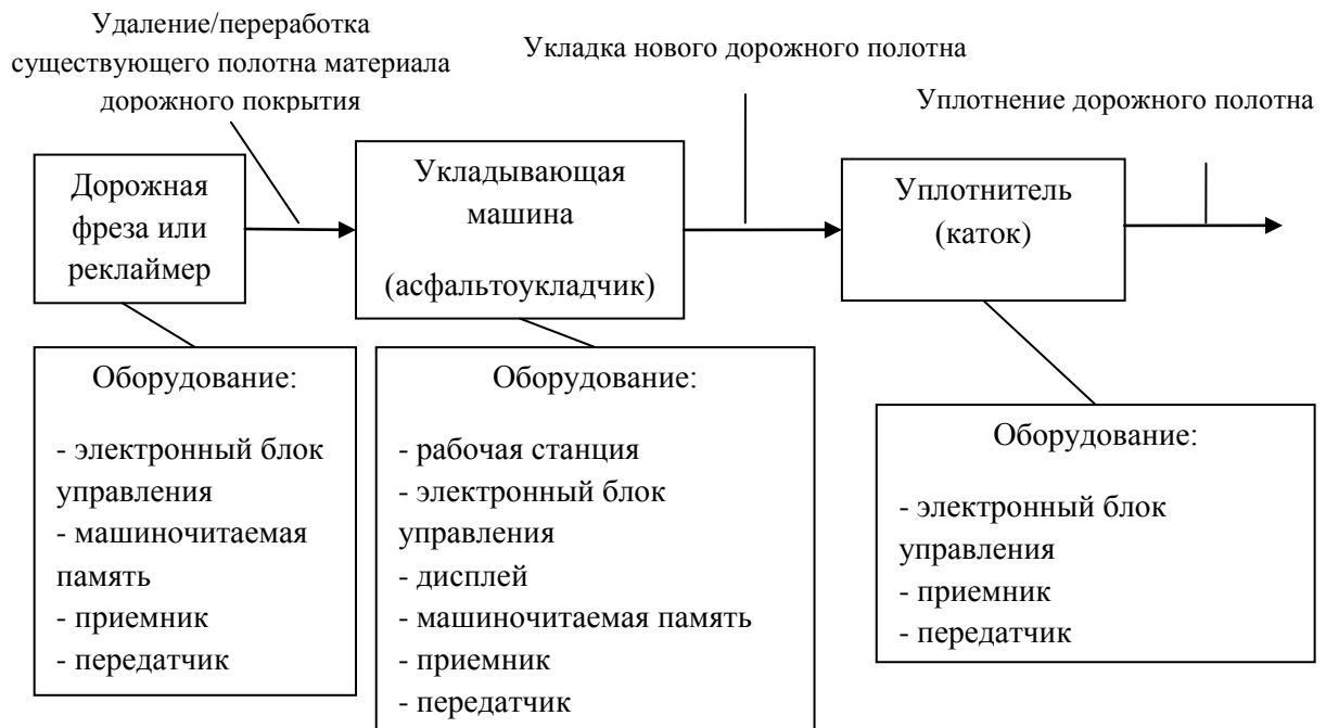
Рис. 2. Схема системы укладки дорожного полотна с учетом сегрегации
