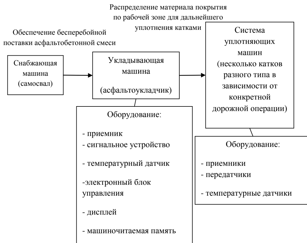
Рис. 1. Схема системы укладки на основе позиционной температурной модели
