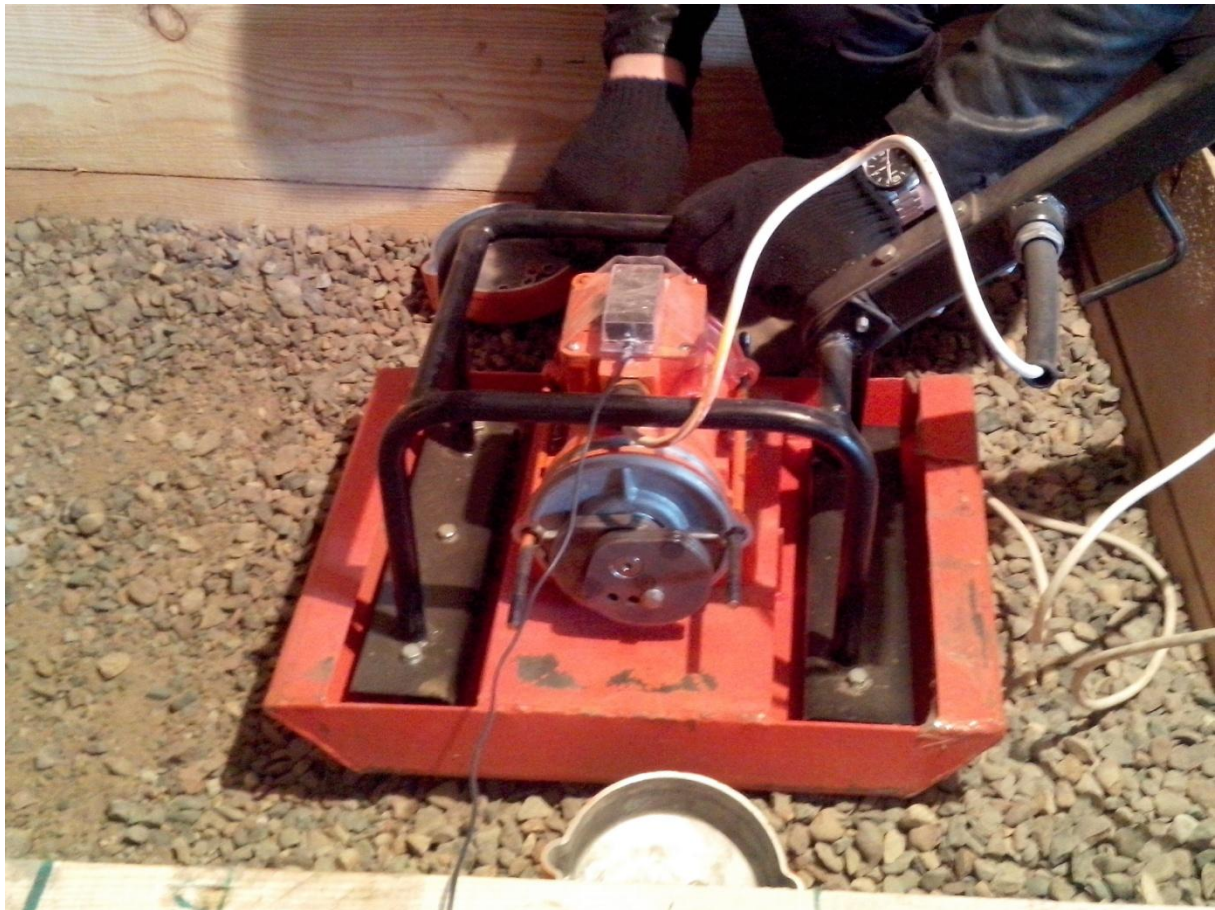
Рисунок – Общий вид вибрационной плиты с установленным акселерометром
