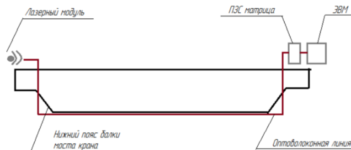
Рисунок 3 – Схема системы контроля металлоконструкций крана.
