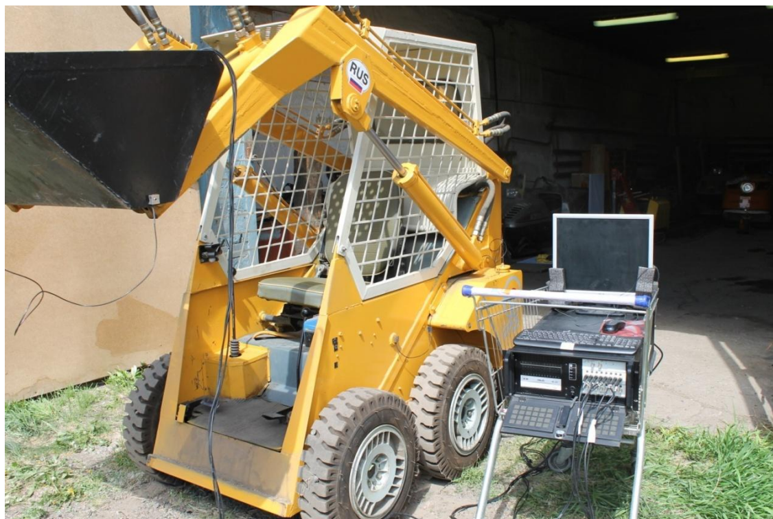
Рисунок 1. Эксперимент по определению динамических параметров рабочего оборудования УМП Соболь с использованием измерительно-вычислительного комплекса ВК-01
