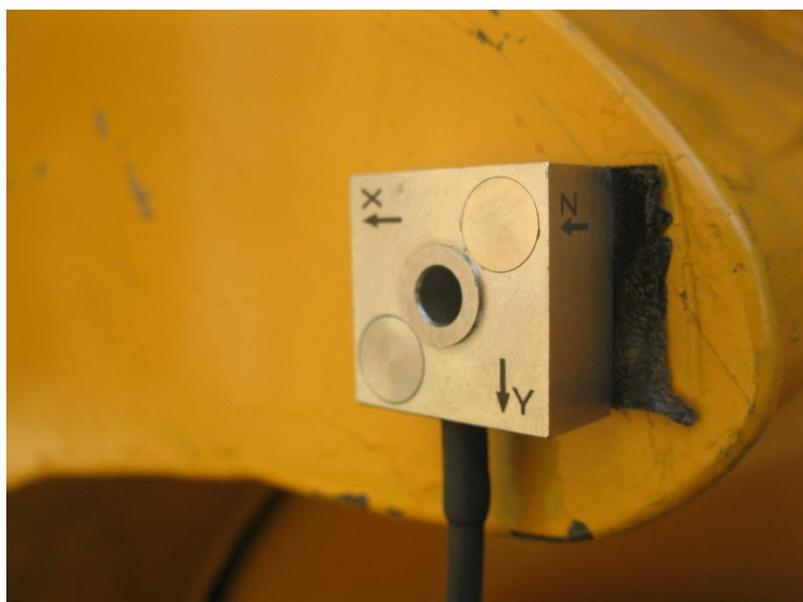
Рисунок2. Датчик установленный на корпусе УМП.
