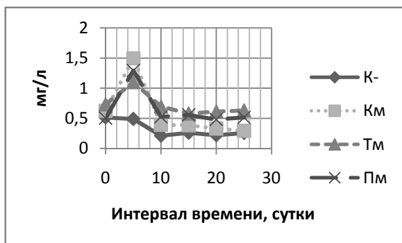
Рисунок 2. Динамика выхода азота из препаратов мочевины в почву; К- – отрицательный контроль, К м – положительный контроль (внесение свободной мочевины), Т м – таблетки с 30%-ным содержанием мочевины, П м – пленки с 30%-ным содержанием мочевины.
