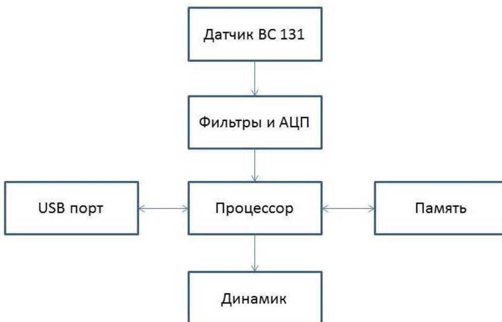
Рисунок 2 Структурная схема устройства.
