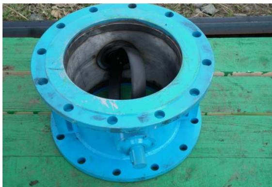
Рисунок 1 - Ортогональная турбина
