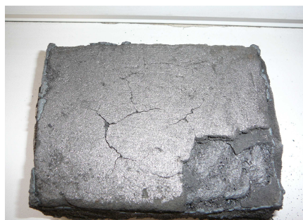
Рисунок 1 – Фотография образца чугуновой отливки с пригаром
