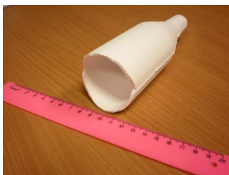
Рисунок 1 - Экспериментальный образец керамических контейнеров
