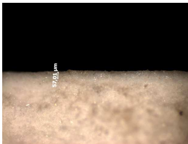
Рисунок 3 – Микрофотография керамики с нанесенным покрытием \text{SiO}_2
