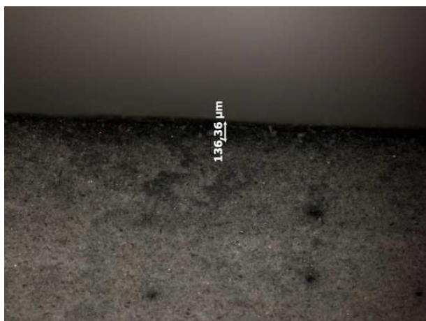
Рисунок 4– Микрофотография керамики с нанесённым углеродным покрытием
