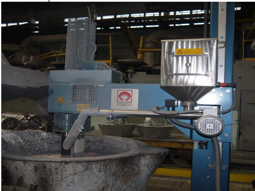
Рисунок 1 – Внешний вид установки для введения комплексного флюса COVERALMTS 1582 производства FOSECO
