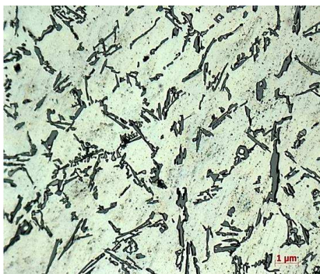
Рисунок 1.1 - Микроструктура сплава АК12 в литом состоянии
