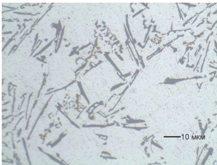
Рис. 4. Структура сплава АК12 с соотношением Fe:Mn = 1:1
