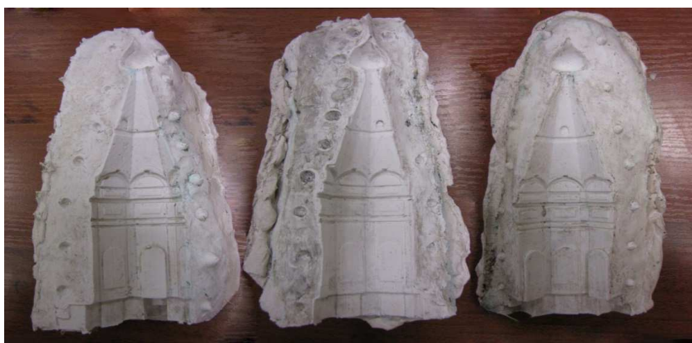
Рисунок 5 – форма из компаунда для получения модели «часовня»
