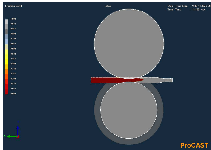
Рис. 3. Модель кристаллизации металла в валках при различной скорости вращения валков: a – 1 об/мин; б – 4 об/мин
