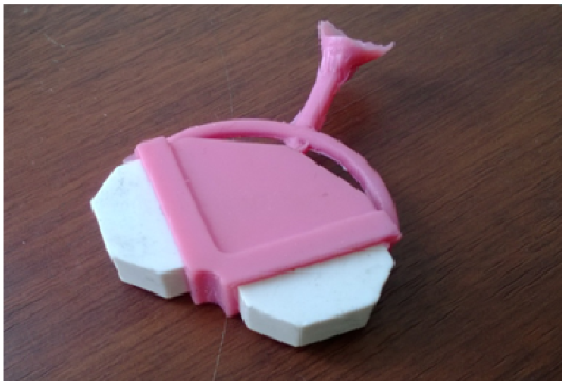
Рисунок 5 – Восковая модель для уголка модели 106.
