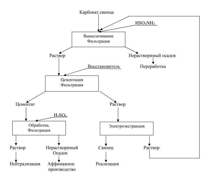
Рисунок 1 – Схема переработки карбонатных осадков свинца
