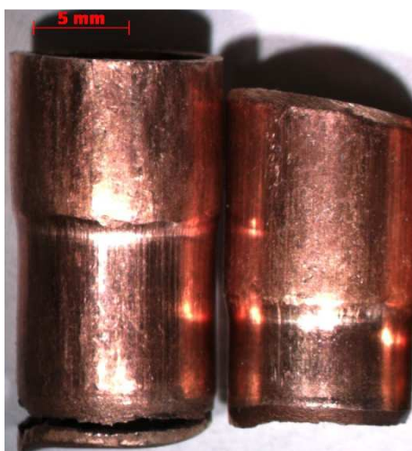
Рисунок 1 - Дефекты при вытяжке заготовок из бериллиевой бронзы
