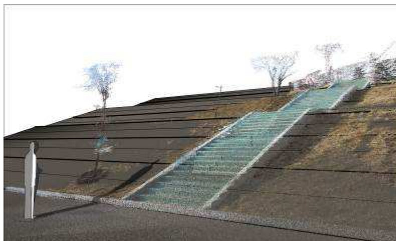
Рисунок5: совмещение результатов фотограмметрического сканирования и построенной по ним поверхности рельефа в Autodesk Revit
