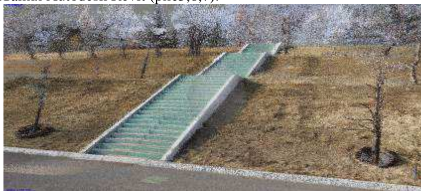
Рисунок4:цветное облако точек[5],полученное в результате обработки лестницы в программе Agisoft Photoscan.
