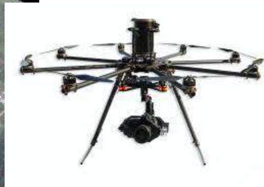
Рисунок1: трехмерная модель рельефа, полученная при помощи беспилотного комплекса БПЛА; Рисунок2: октокоптер для аэрофотосъемки.
