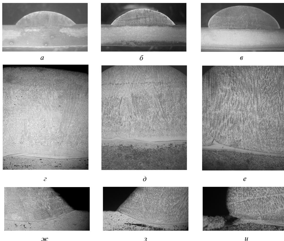
Рис. 2. Структура наплавки различными способами в поперечных сечениях валиков.
