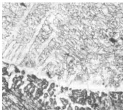
Рис. 1. Микроструктура участка сплавления основного металла стали 20 с наплавленным типа 05X2М,  $\times 550$  [1]
