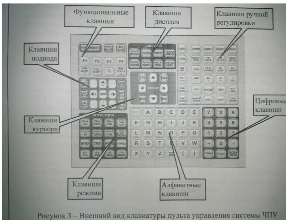
**Функциональные клавиши.** Клавиши F1-F4- эти клавиши имеют разные функции в зависимости от режима работы (программирования, редактирования, коррекции).
