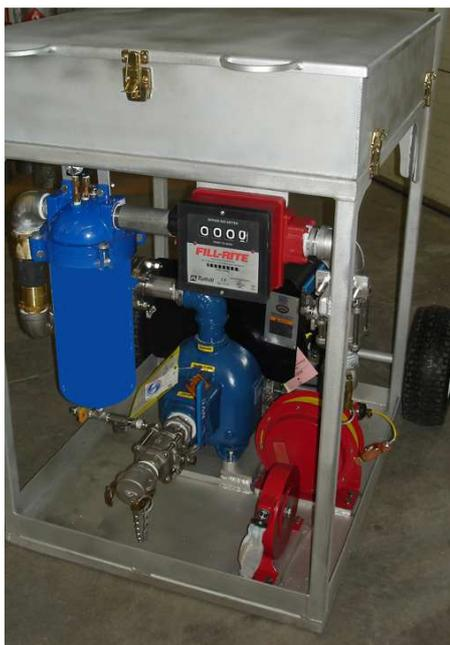
Рис. 4 – Портативная установка по очистке реактивного топлива
