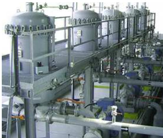
Рис. 1 - стационарная установка для очистки реактивного топлива
