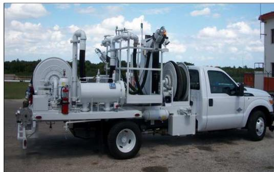
Рис. 3 – Мобильная установка по очистке реактивного топлива
