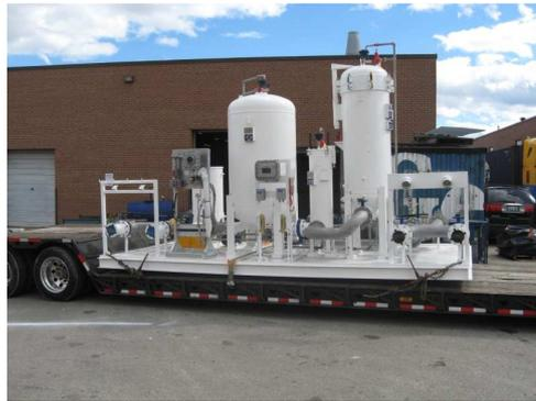
Рис. 2 –Установка по очистке реактивного топлива
