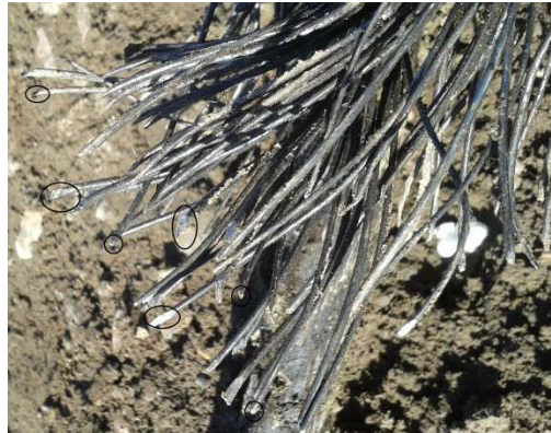
Рисунок 4 – Характер обрыва проволок сечения каната
