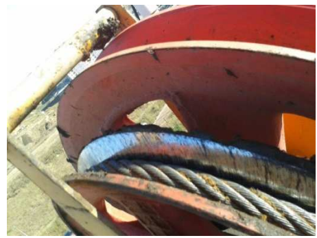
Рисунок 3 – износ реборды блока по внутренней поверхности
