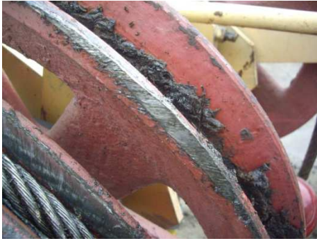
Рисунок 2 – износ реборды блока по внешней поверхности
