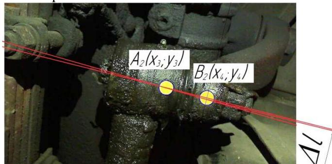
Рисунок 8 – Второе крайнее положение соединения рулевой сошки и продольной рулевой тяги
