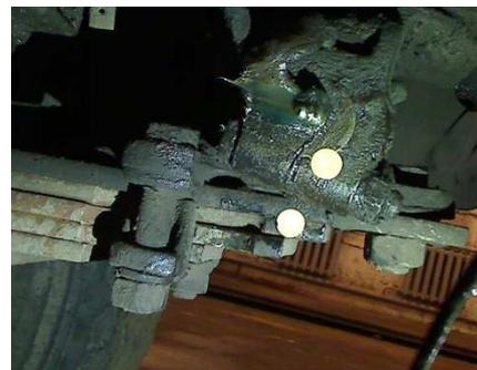
Рисунок 6 – Место крепления передних рессор
