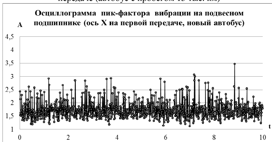
Рисунок 4 – Диагностика подвесного подшипника карданной передачи на первой передаче (новый автобус)
