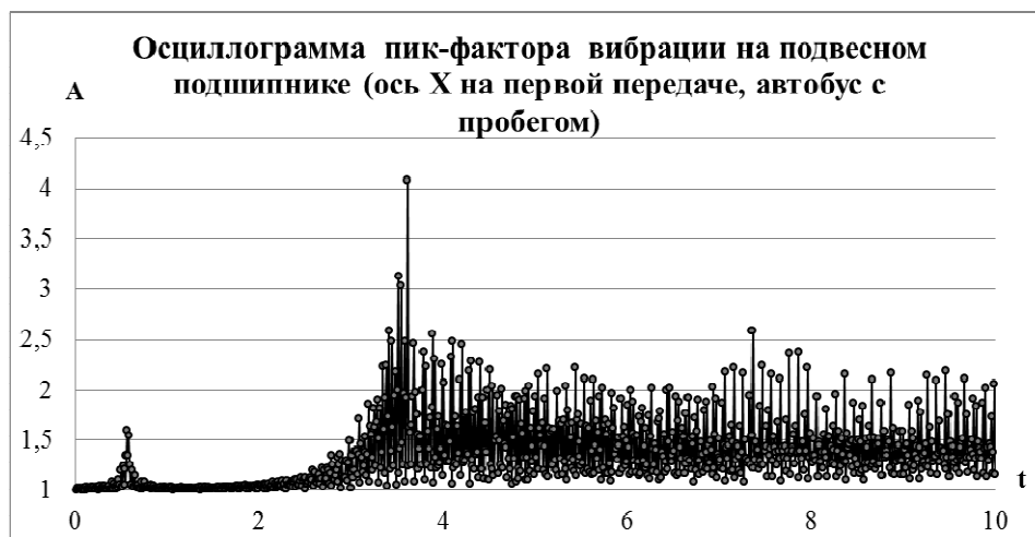
Рисунок 3 – Диагностика подвесного подшипника карданной передачи на первой передаче (автобус с пробегом 15 тыс. км)
