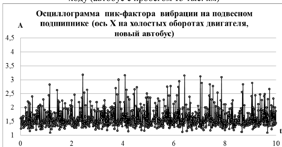
Рисунок 2 – Диагностика подвесного подшипника карданной передачи на холостом ходу (новый автобус)
