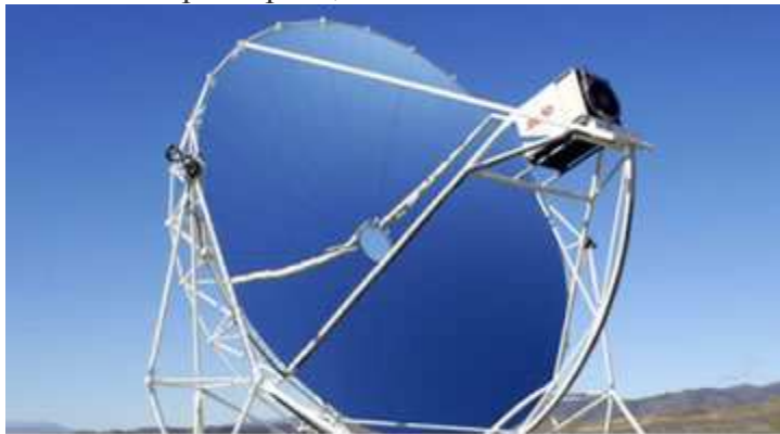
Экспериментальная гелиоэлектростанция на основе Стирлинга
