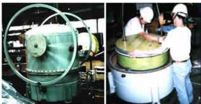
Японский экспериментальный низко температурный гама-стирлинг. Мощность - 300Вт, температура нагревателя 150С
