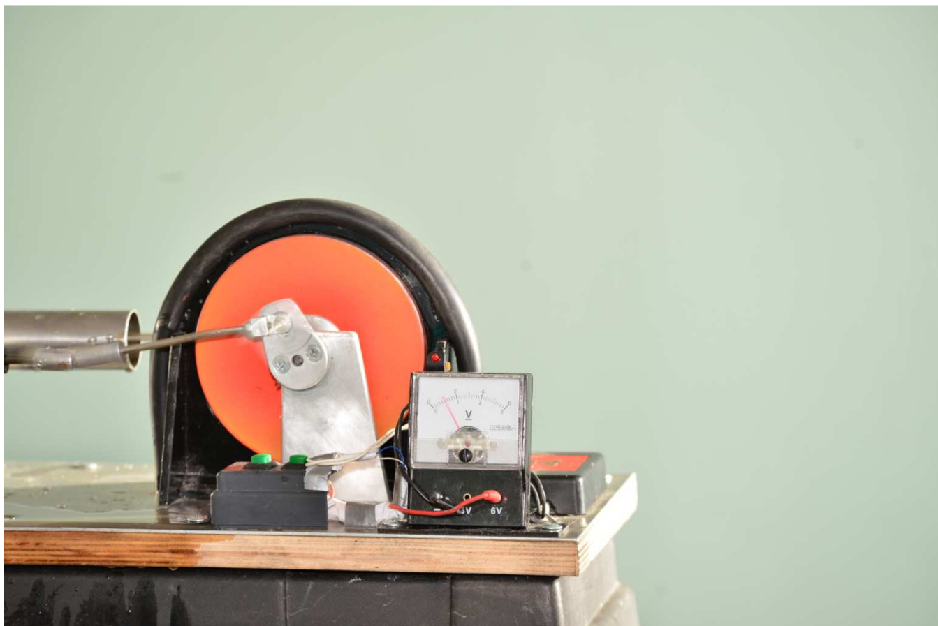
Рис. 7 На максимальных оборотах генератор выдаёт до 10 V постоянного тока. Переменный трёхфазный ток, который выдаёт генератор выпрямляется диодным мостом (виден справа от вольтметра)
