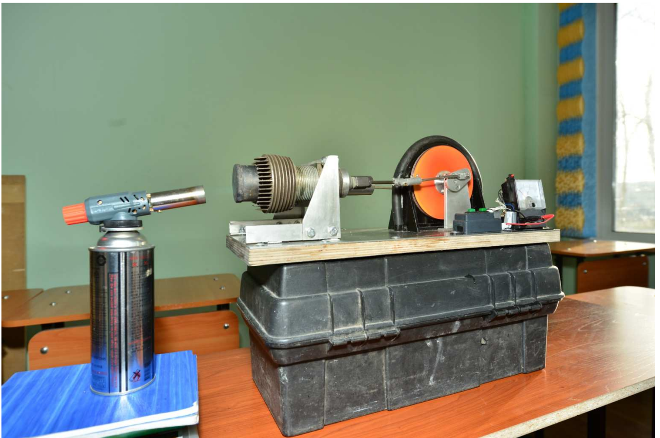
Рис. 4 Высокотемпературный Стирлинг с генератором
