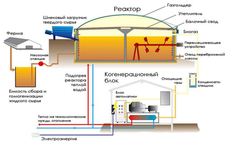
Рис. №1. Схема работы современной биогазовой установки.
