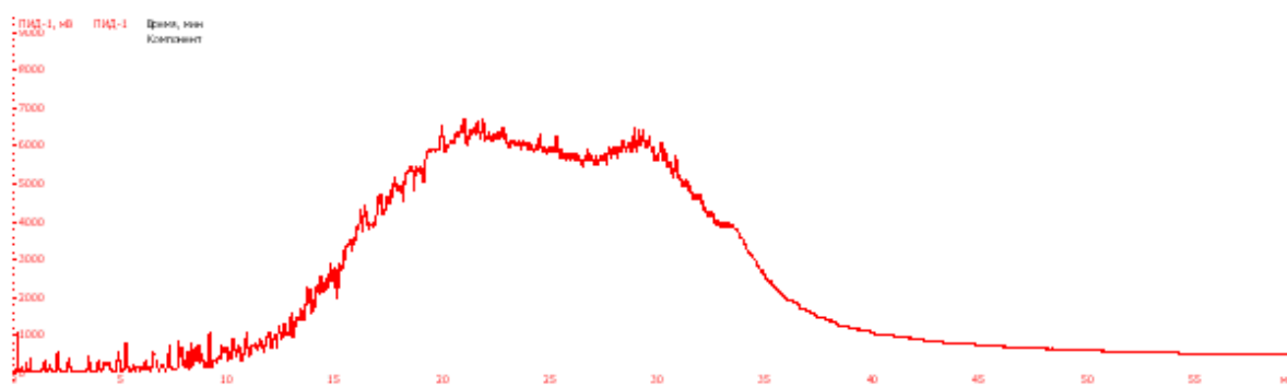
Рис. 1. Хроматограмма сырой нефти Русского месторождения (метод имитированной дистилляции).
