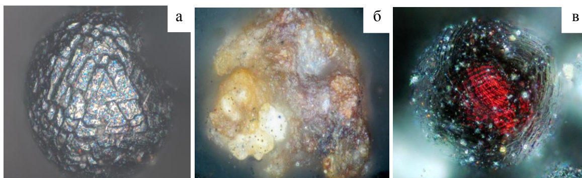
Рисунок 2. Распределение алюмосиликатной части в глобулах: а – внутри, б, в – на поверхности.
