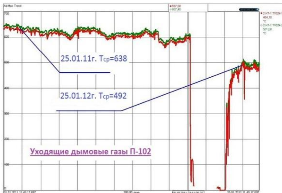
Рисунок 6 – Тренд температуры уходящих дымовых газов «до» и «после» нанесения энергоэффективного покрытия.
