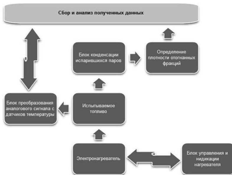
Рис. 1. Блок-схема работы установки для определения качества фракционного состава топлива
